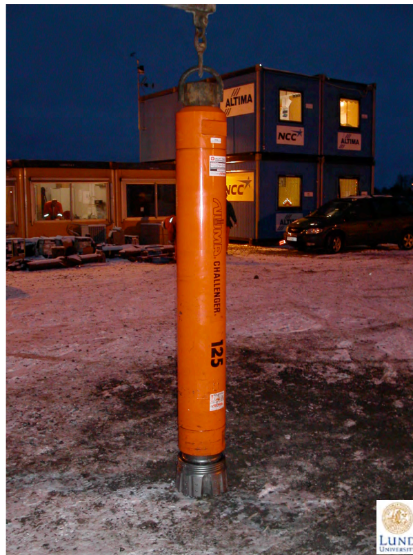
Fig. 13. Hammarborrutröstning med 12 ¼” borrhkrona använd i Lund 2003.
