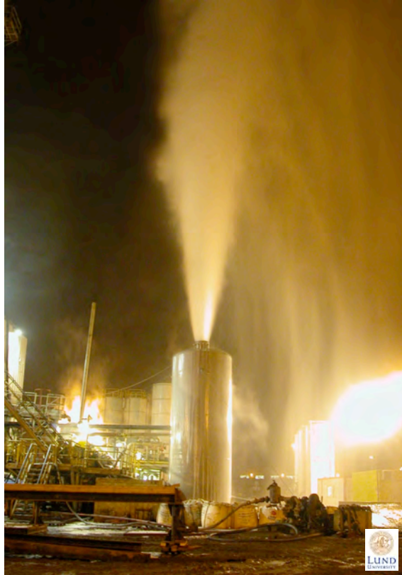
Fig.16. Evakuering av borrhål vid underbalanserad borrning.
