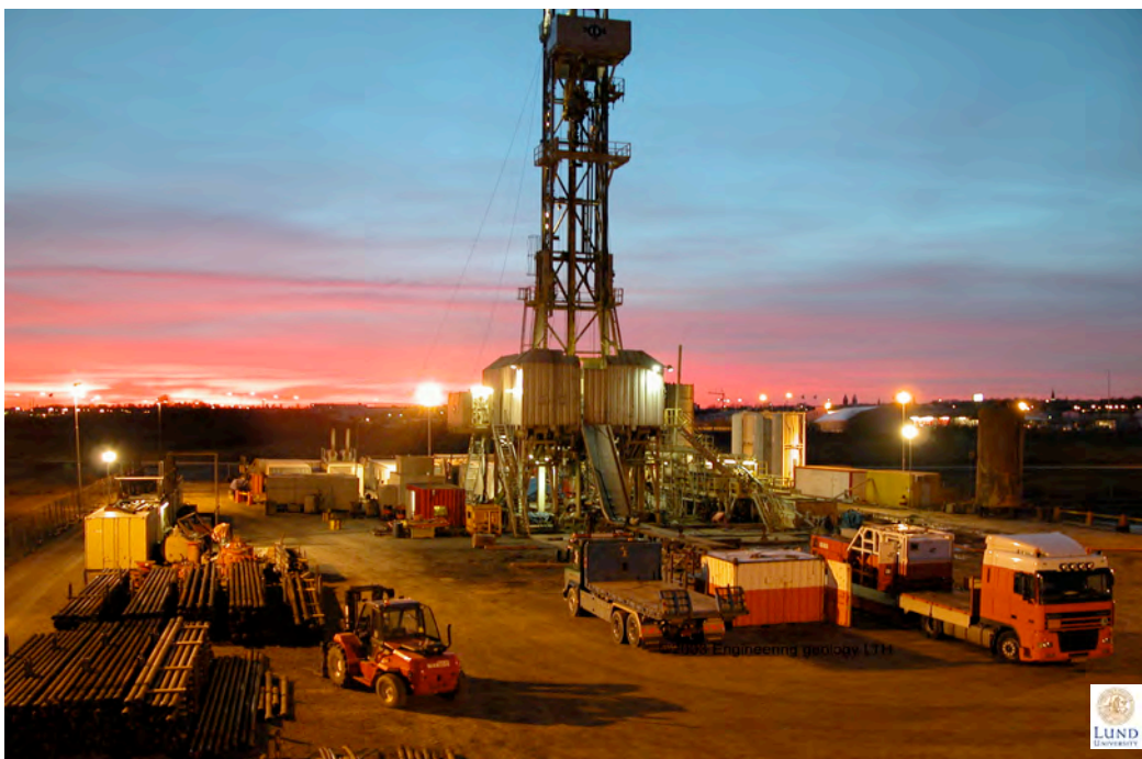
Fig. 9a. Modern borrplats under full operation för stora borrhjup, ca 4000 m. Lund 2002/2003.
